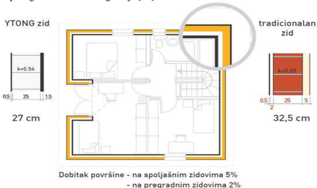
Slika 3. Uporedna analiza Ytong i tradicionalnog zida [16].
