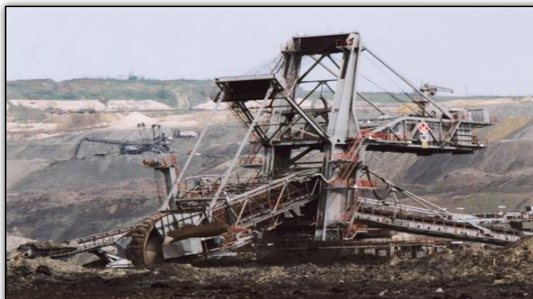
Slika. 1. Rotorni Bager ERs1200*22/2 na površinskoj eksploataciji
