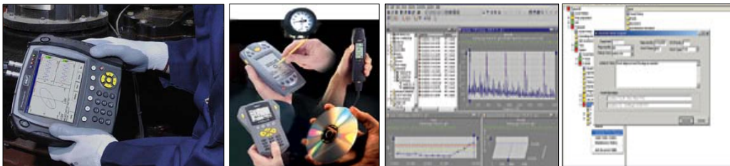
Slika 2. Prikaz vibro analize sa detektovanim odstupanjima prema (SKF)
